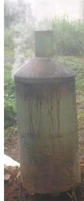
Gambar 2 proses pembuatan arang dengan tungku *drum kiln*
