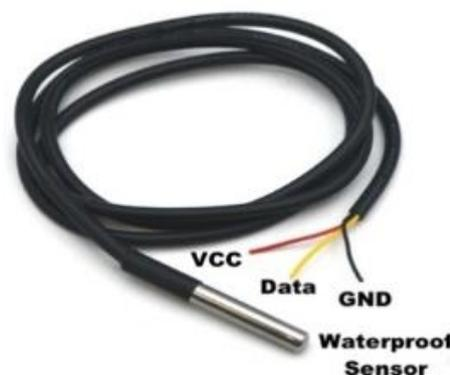
Gambar 1. Bentuk Sensor Suhu DS18B20
