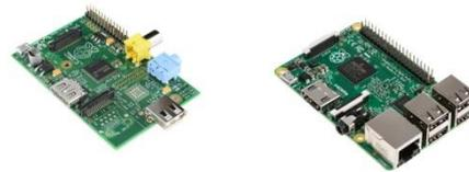
Gambar 1. Raspberry Pi Model A (kiri) dan Raspberry Pi 2 Model B (kanan)
