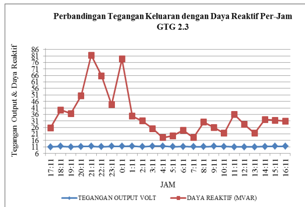
Gambar 7. Grafik Hubungan Tegangan Keluaran dengan Daya Reaktif GTG 2.3
