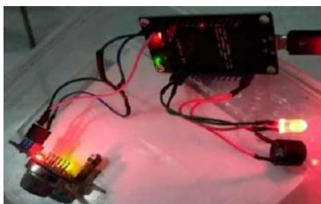
Gambar 18, pengujian notifikasi dari mikrokontroler ke LED dan BUZZER
