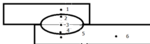
Gambar 6 Titik pengujian kekerasan area; 1. Haz, 2. Las, 3. Las, 4. Las, 5. Haz dan 6. Base Metal
