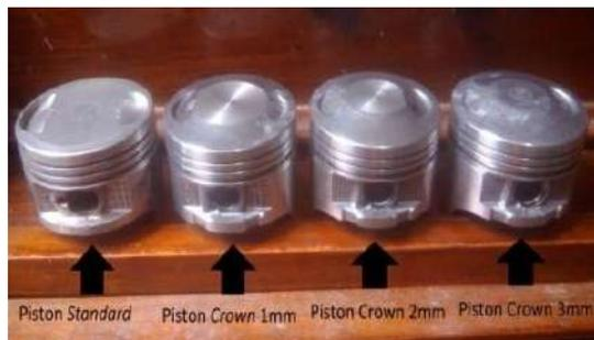
Gambar 2. Spesimen Uji
