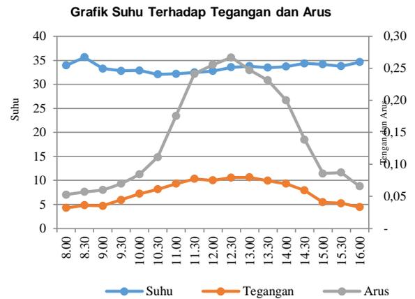
Gambar 5. Suhu terhadap tegangan dan arus solar cell
