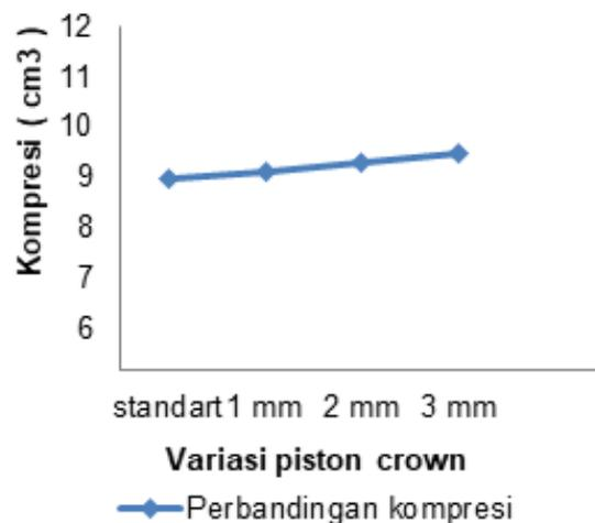
Gambar 6. Perbandingan Kompresi dengan Variasi *Piston Crown*
