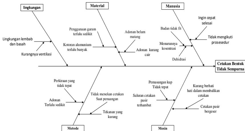
**Gambar 6** Fishbone Diagram Cetakan Bentuk Tidak Sempurna
