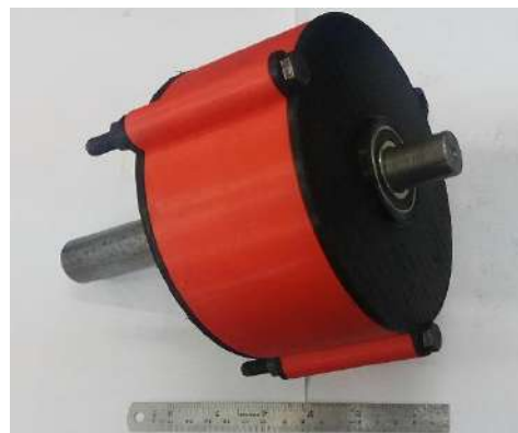
Gambar 3. Sebuah prototipe generator hasil pencetakan 3D menggunakan material ABS.
