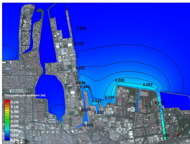
Gambar 8. Permodelan sedimen pelabuhan Sunda Kelapa (time step: 180 hari).
