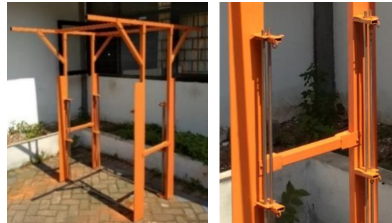
Gambar 1 (kiri) Frame VIVEC, (kanan) sistem slider VIVEC
