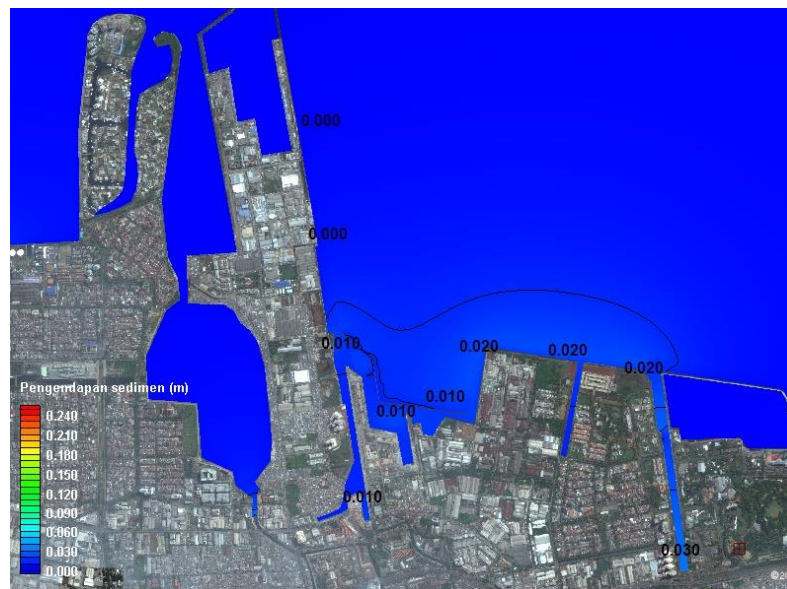
Gambar 7. Permodelan sedimen pelabuhan Sunda Kelapa (time step: 30 hari).
