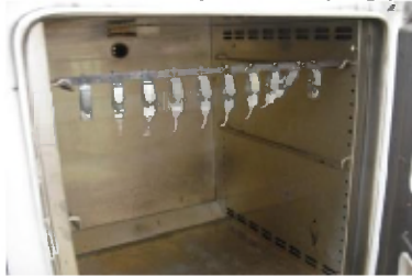
Gambar 3 Proses penuaan dengan oven
