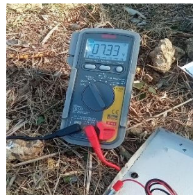
a. pengukuran dengan multimeter b. pengukuran dengan voltage sensor Gambar 5 Pengujian pengukuran tegangan dengan multimeter dan voltage sensor
