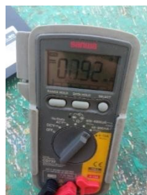
a.pengukuran dengan multimeter b.pengukuran dengan sensor INA219 Gambar 4 Pengukuran arus menggunakan multimeter dan INA219
