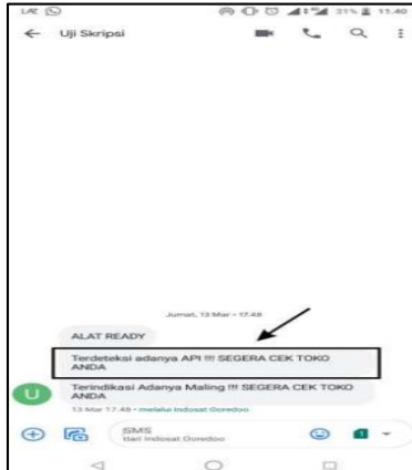
Gambar 11. Tampilan Pesan SMS Saat Pendeteksi Kebakaran Aktif
