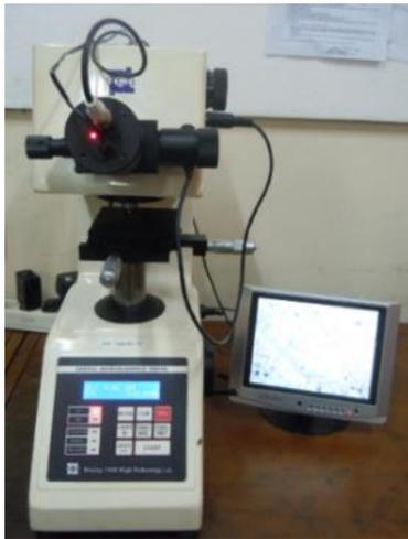
Gambar 7 Mesin Uji Kekerasan Vickers
