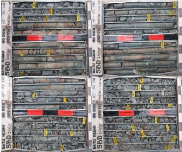
Gambar 4. Interval batuan kalk silikat diantara breksi andesit vulkanik dengan kategori RQD buruk
