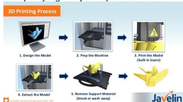
Gambar 4. Langkah-langkah proses pencetakan part 3D
