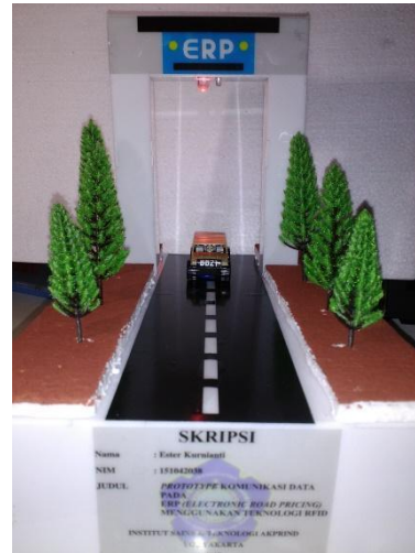
Gambar 9. LED Merah ON, kendaraan telah terdaftar.
