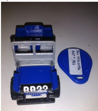
Gambar 8. Kendaraan dipasang tag RFID
