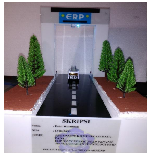
Gambar 10. LED kedip ON, kendaraan belum terdaftar
