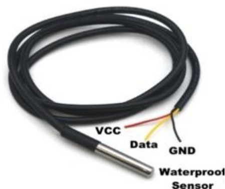
Gambar 1. Bentuk Sensor Suhu DS18B20 ( https://www.intellihome.be/en/waterproof-temperature-sensor-ds18b20.html )
