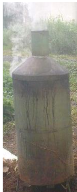
Gambar 2 proses pembuatan arang dengan tungku drum kiln
