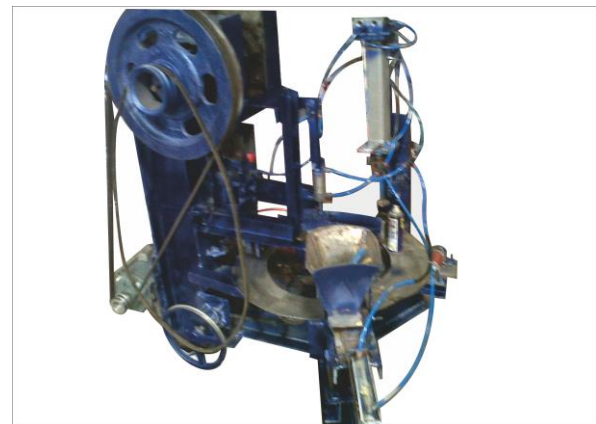
Gambar 7. Mesin Pencetak Garam Briket Otomatis Hasil Penelitian
