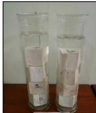
Gambar 8. Perendaman sample selama 24 jam (Penulis, 2017)
