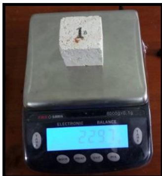
Gambar 7. Penimbangan sample setelah dikeringkan (Penulis, 2017)
