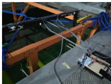
Gambar 3 (atas) Sistem pengujian VIVEC pada kereta uji towing tank , (bawah) sistem sensor pada VIVEC
