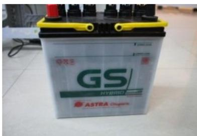
Gambar 5. Baterai *Wet Cells* 12 Volt 45 Ah
