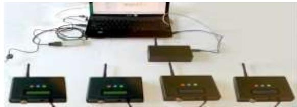
Gambar 4. Sistem Telemetri *Multinode* Gas Ammonia Secara Keseluruhan
