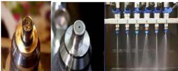
Gambar 4. Injektor Lama dan Baru Serta Bentuk Semprotan Yang Baik dan Tidak Baik (sumber Toyota Astra Motor 2003; 60)
