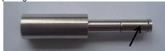
Rolling tools yang bisa berputar dan digunakan untuk me-roll lubang DCP
