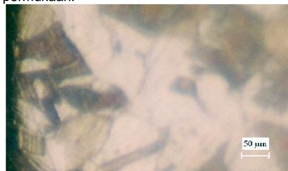
Gambar 8. Gambar struktur mikro sebelum penekanan atau setelah permesinan.
