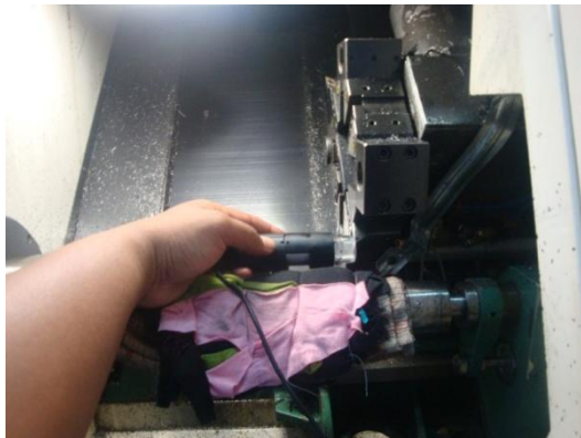
Gambar 6. Posisi microscope saat pengambilan citra
