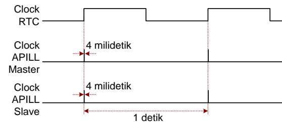
Gambar 7 Isyarat clock keluaran prosesor kedua APILL
