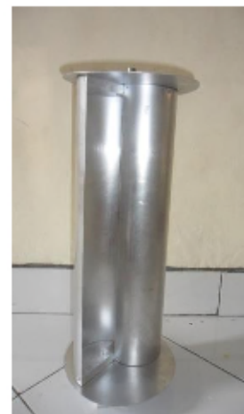
Gambar 3. Dimensi rotor turbin Savonius tipe II yang digunakan
