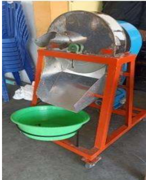
Gambar 3. Mesin pemotong singkong yang dirancang dan dibuat untuk kegiatan pengabdian masyarakat
