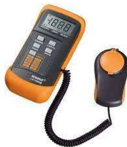
Gambar 4. Luxmeter untuk mengukur pencahayaan tempat kerja
