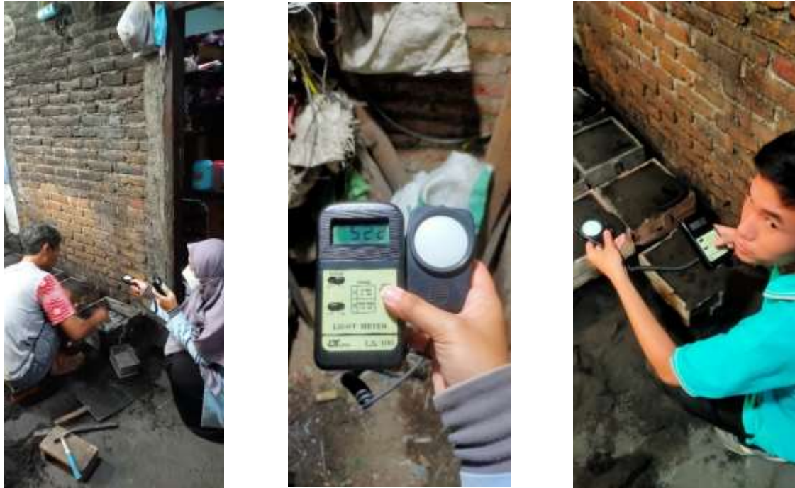
Gambar 5. Proses Pengukuran Pencahayaan
