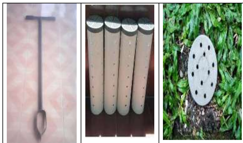
a. Bor tanah b. Pralon berlubang c. Penutup biopori
