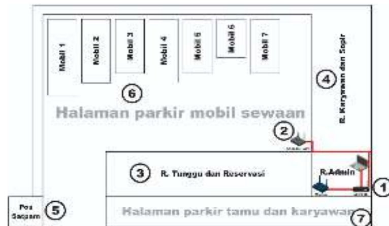
Gambar 1. Rancangan jaringan hotspot di kantor Meccaylarentcar
