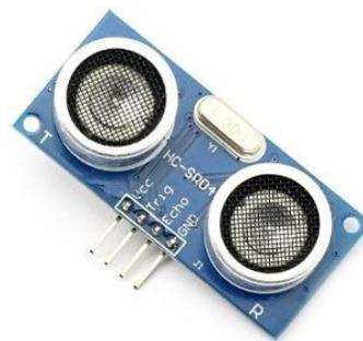
Gambar 2.1. Bentuk Fisik Modul Sensor *Ultrasonic*
