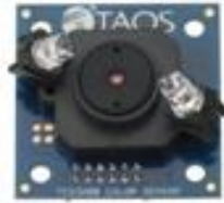
Gambar 3. Contoh perangkat sensor RGB menggunakan TCS230
