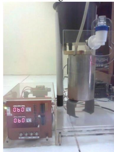
Gambar 11 Unjuk kerja sistem kendali PID pada tangki pemanas air untuk fasilitas rumah tangga berbasis mikrokontroler Atmegaa32
