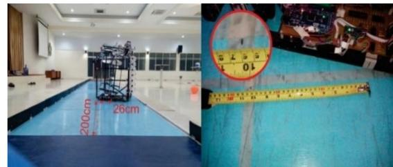
Gambar 3. 2 a) Pengujian Pergerakan Robot *Open Loop* dari Titik A ke Titik B b) *Error* Pergerakan Robot *Open Loop* dari Titik A ke Titik B
