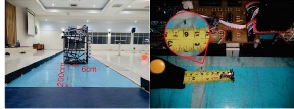
Gambar 3. 9 a) Pengujian Pergerakan Robot kontrol PID dari Titik A ke Titik B b) *Error* Pergerakan Robot kontrol PID dari Titik A ke Titik B
