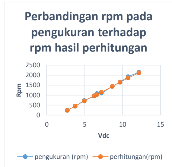
Gambar 3.3 Grafik perbandingan rpm pada pengukuran terhadap rpm hasil perhitungan.
