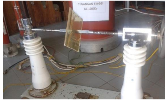
Gambar.6 Bahan uji sudah dipasang di Elektroda
