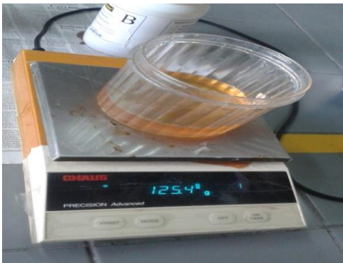
Gambar 2. Penimbangan dan Pencampuran bahan Epoxy Resin dan Epoxy Hardener
