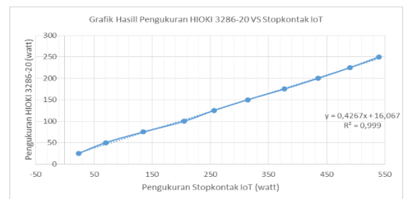
Gambar 8. Grafik Lineritas Hasil Pengukuran HIOKI 3286-20 vs stopkontak IoT
