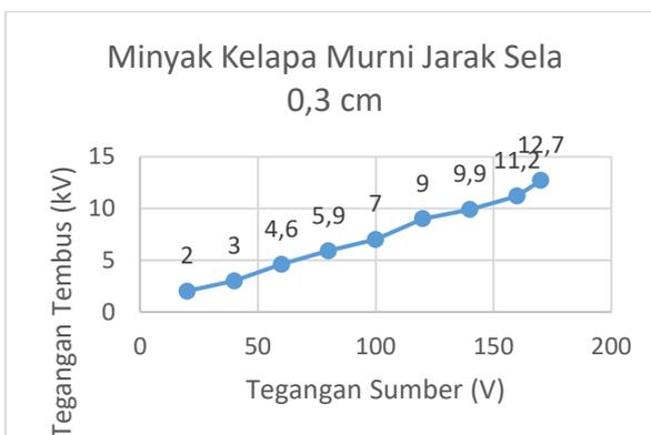
Gambar 14 Tegangan tembus minyak kelapa murni dengan sela gap 0,3 cm
