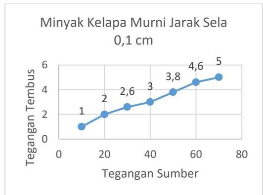
Gambar 12 Tegangan tembus minyak kelapa murni dengan sela gap 0,1 cm
