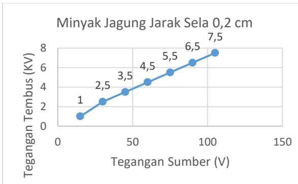
Gambar 8 Tegangan tembus minyak jagung dengan sela gap 0,2 cm
