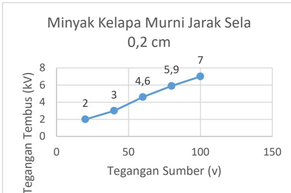
Gambar 13 Tegangan tembus minyak kelapa murni dengan sela gap 0,2 cm
