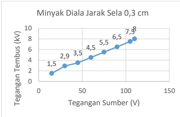
Gambar 6 Tegangan tembus minyak diala dengan sela gap 0,3 cm
