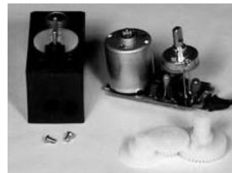
Gambar 3 Konstruksi motor servo
