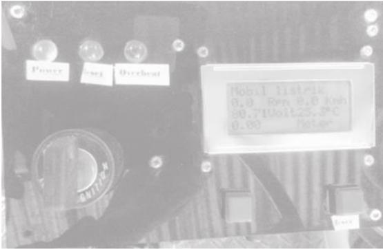
Gambar 3. Bagian kontrol dan penampil data dengan LCD
