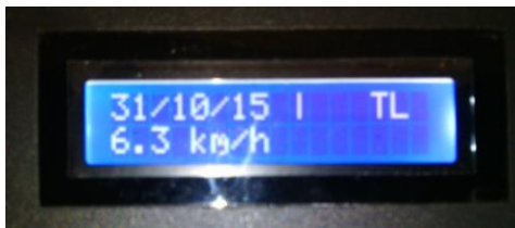
Gambar 3.2 Tampilan Kecepatan Dan Arah Angin Pada LCD
