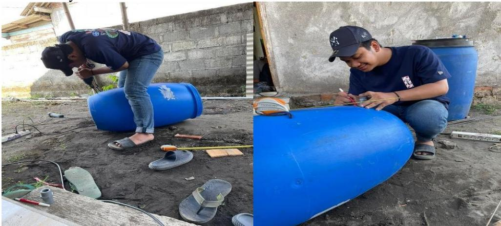
Gambar 2. Pembuatan Lubang 5 dan 15 cm dari dasar.
