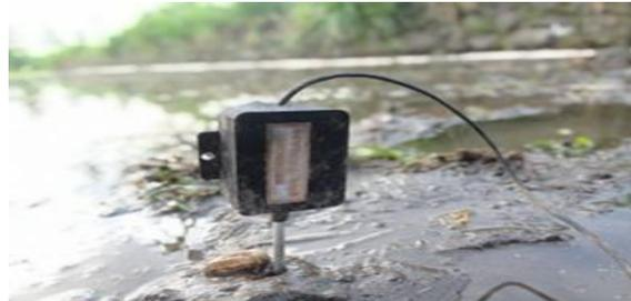
Gambar 6. Sensor pH tanah
