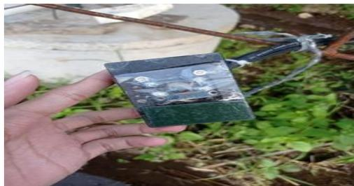
Gambar 7. Sensor warna TCS3200
