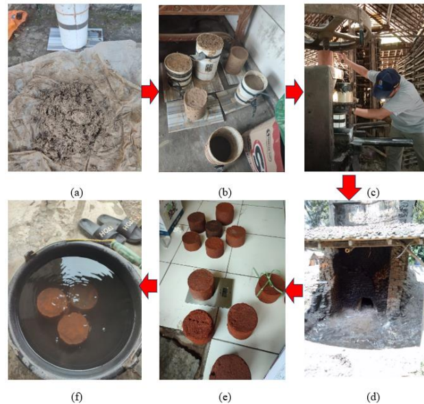
Gambar 6. Menunjukkan tahapan pembuatan keramik berpori (a) Pengolahan tanah liat (b) Pencetakan keramik pori (c) Pengepresan green part (d) Pembakaran (e) Keramik membran (f) Finishing produk membran.
