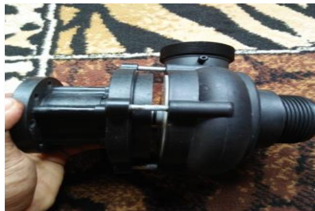
4) Pemasangan Rumah Casing
