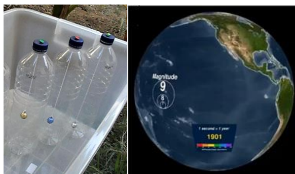
Gambar 2. Botol dengan ayunan bandul yang dikreasi menjadi alat detektor gempa dan tampilan aplikasi virtual tiga dimensi lokasi fenomena gempa dan besaran skala kekuatannya mulai tahun 1900 hingga 2000.
