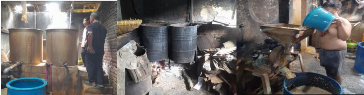
Gambar 1. Tangki Perebusan kedelai modern dan tradisional dan Alat Pemisah kulit kedelai
