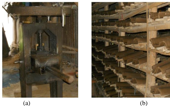
Gambar 2. (a) Mesin press semi otomatis (b) Rak bambu untuk pentiris genteng basah.
