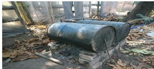
Gambar 4. Pemanasan saat Proses Penanaman Jamur Merang Dengan Menggunakan Alat Konvensional
