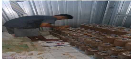
Gambar 2. Proses Pembibitan/ Pengisian Baglog Secara Manual
