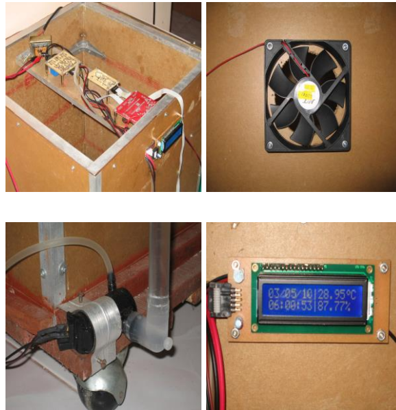
Gambar 5. Piranti elektronis kumbung otomatis
